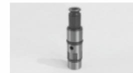
Втулка шпинделя Твердость: HRC58-63 Шероховатость поверхности: Ra0.6µm CPK = 1.7
