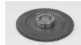
Внутр. отверстие шестерни Твердость: HRC58-63 Шероховатость: Ra0.4µm Округлость: 0,002 мм Точность обработки: IT5
