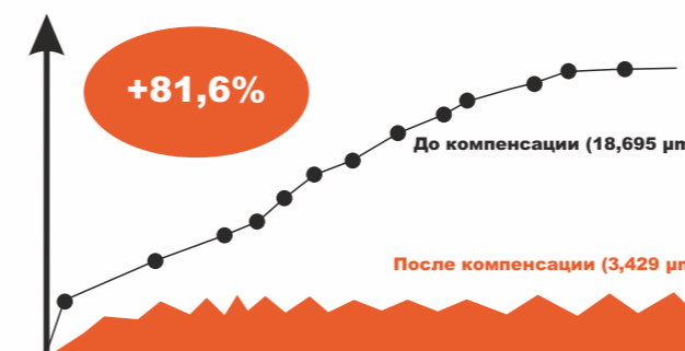
Компенсация тепловой деформации по оси X
