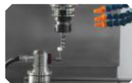
Датчик настройки и привязки инструмента (опция)
